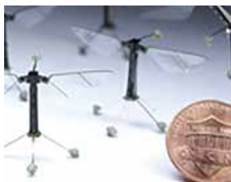
ハーバード大学で開発されたハエロボットは、翼長3cm、重さはわずか80mg。脳のニューロンを模した、コーネル大学のアルゴリズムでいよいよ本物のハエのように飛べるようになる? Photo by Cornell University
