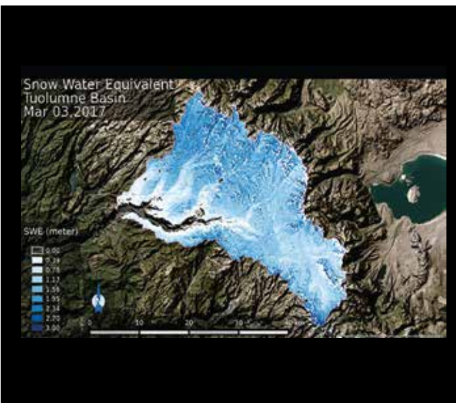
パルスレーザーを用いて観測された、シエラネバダ山脈の積雪。 雪の状態も分析することで雪解けのタイミングも推定できる (Image by NASA)
