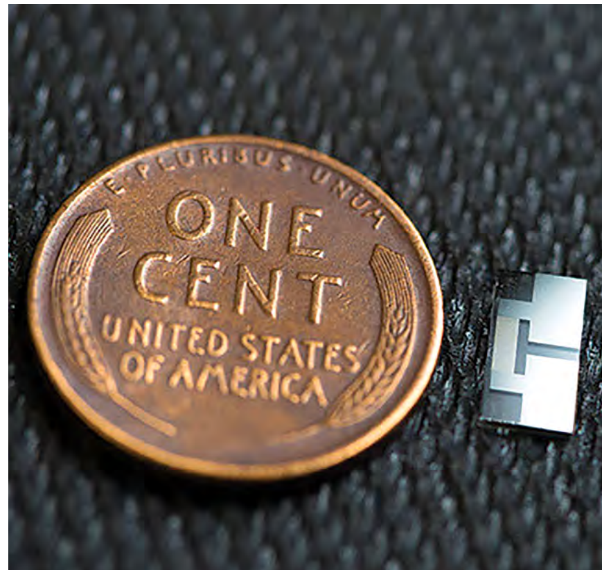
カリフォルニア大学サンディエゴ校が開発した超音波放射デバイス。 超音波で電解液中に循環電流を生じさせ、電池の劣化を防ぐ。
