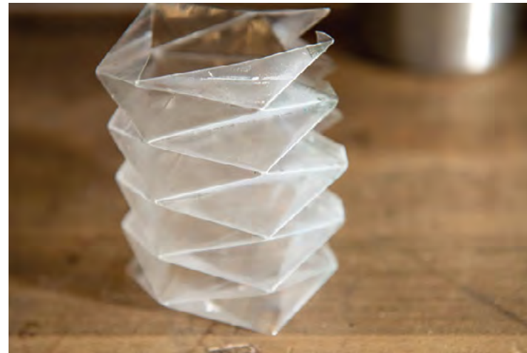
ポリエステルフィルムで作られた蛇腹構造のタンクは、極低温下でも壊れない。 Photo by Washington State University
