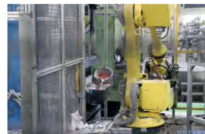
▲ 内外はAIを活用したアルミ鋳造の自動化ラインを構築
